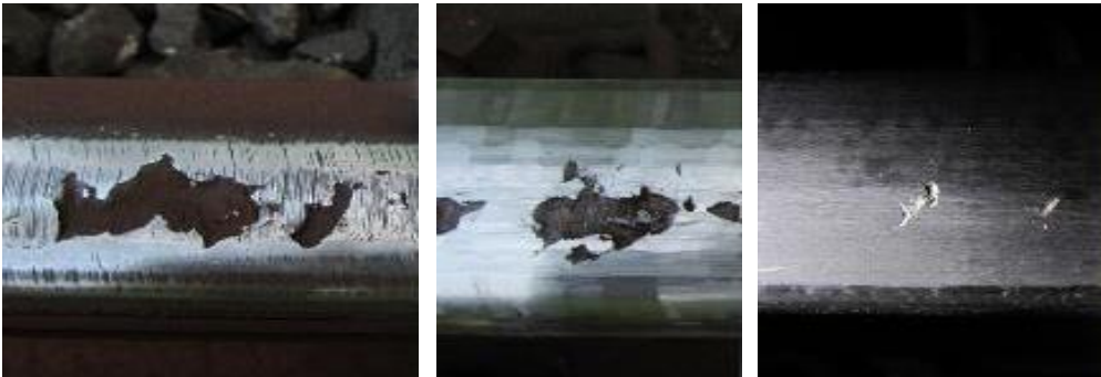
Vollständige Wiederherstellung des Querprofils und Beseitigung der Schienenfehler nach vier Überfahrten mit insgesamt 3,6 mm Abtrag.
